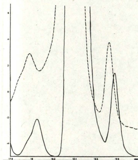
Fig. 14: Superposition des chromatogrammes d'un même échantillon sans ajout de 2 % d'ammonium acétate (.....) et avec (—). Vue sur les chlorophylles a .
