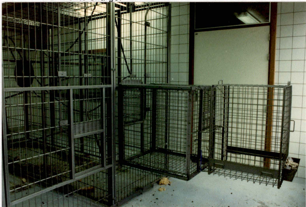
Figure 2.3 Cages A (à droite) et B (à gauche). Ces 2 cages sont accrochées l'une à l'autre par un système de crochets. Elles sont en communication directe avec la grande cage (à gauche) mais peuvent en être séparées par la "guillotine".
