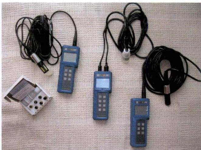
*Fig 2.2 Sondes de mesures physiques (de gauche a droite oxymètre, pH-mètre, conductimètre).*
