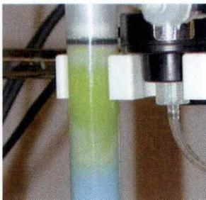
**Figure 23.** Purification de l'UGM « sauvage » sur la colonne d'affinité au nickel. Grâce à la couleur jaune du cofacteur flavinique, il est aisé de suivre l'élution de l'enzyme.
