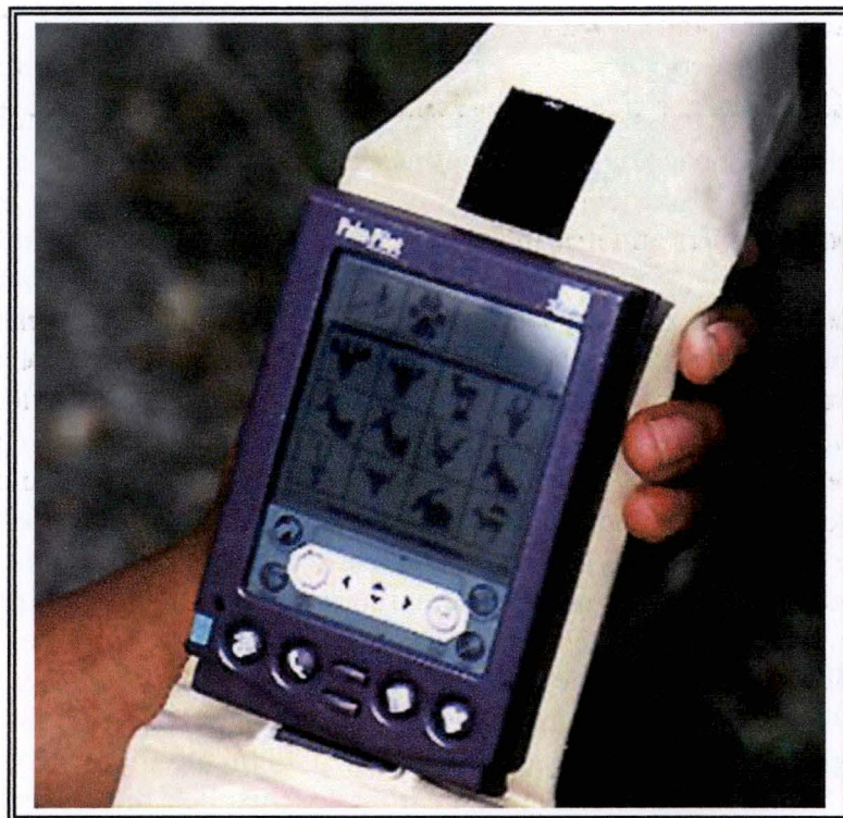
Figure 17 : L'outil "Cyber Tracker"; un processeur à écran tactile couplé à un module GPS. Exemple d'écran présentant différentes icônes.
