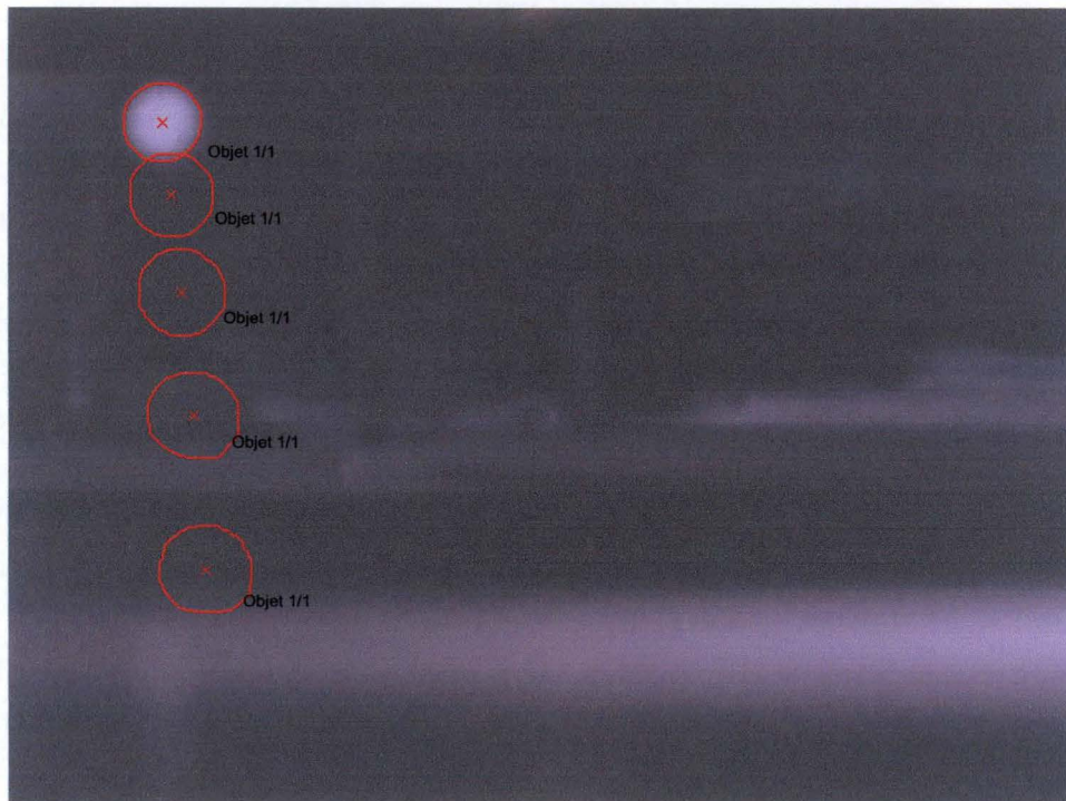
FIG. 5.3 – Suite d'échantillons réalisée avec le stroboscope. La position estimée du centre de gravité de la balle de golf est marquée d'une croix rouge.
