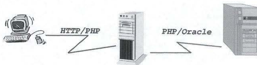
Figure 35 - L'architecture physique de Ganesha et de WEngine
