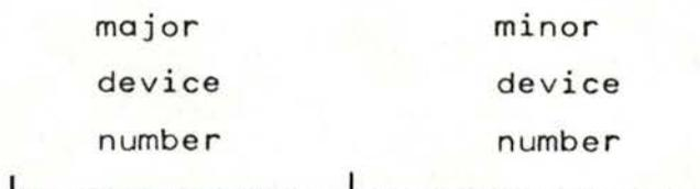
Le "major number" sélectionne quel driver traite ce périphérique; le "minor number" , par contre, n'est pas utilisé par le système, mais est passé comme paramètre au driver, qui l'utilise pour orienter son action vers l'un ou l'autre des périphériques qu'il "conduit".
