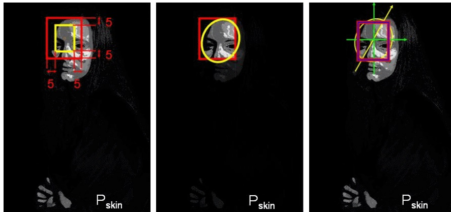
FIGURE 2.5 – Adaptation de la taille de la fenêtre dans le cas du CamShift appliqué au traitement d’images. Auteur : Rachid Belaroussi.
