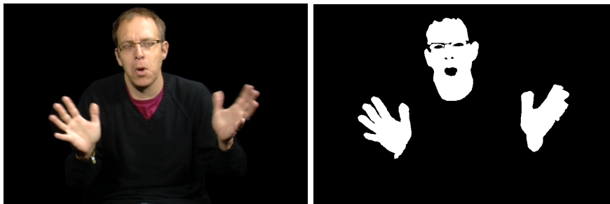
FIGURE 5.2 – Illustration du concept d'image binaire. A gauche, l'image originale (image originale provenant de [21]). A droite, l'image binaire correspondante.
