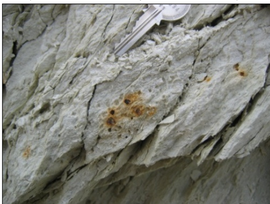
Photo 6 : présence de caries et de pyrites oxydées dans un banc de kaolin (Carrière "Les Baraques" à Transinne).
