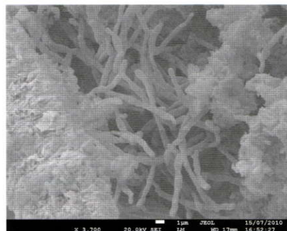
Fig. 26.- Image MEB des micro-organismes envahissant la porosité des mortiers jaunes. © Aline Wilmet.
